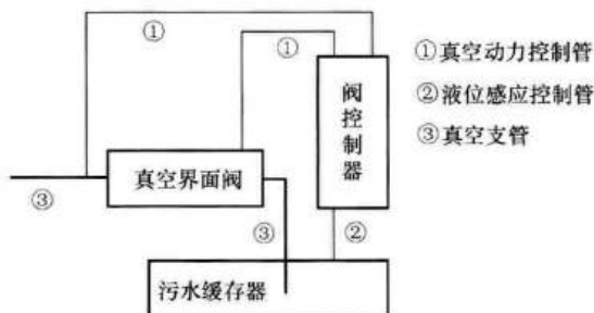
图 3 真空界面单元组成示意
